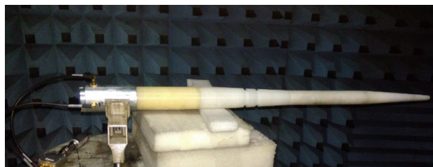
شکل ۱۴- اندازه‌گیری پارامترهای تشعشعی آنتن در اتاق بدون بازتاب
