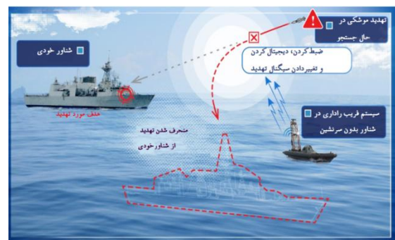
شکل (۱): فریب موشک توسط شناور سطحی بدون سرنشین مجهز به جمر راداری
