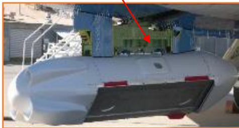
شکل (۱). نمایی از هواپیمای Gulfstream-III آمریکایی به همراه سنجنده UAVSAR آن.
