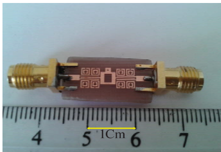
شکل ۱۲. شماتیک فیلتر پیشنهادی
